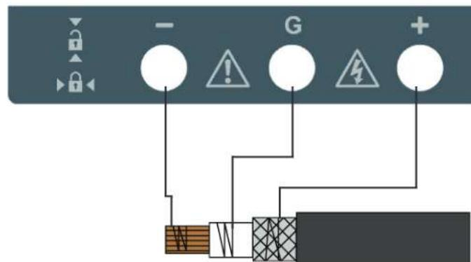
Como se ilustra en el diagrama, el terminal de protección está al mismo potencial como el terminal negativo. Como la resistencia de fuga está efectivamente en paralelo con la resistencia a ser medida, el uso de la protección causa que la corriente en la fuga superficial sea desviada del circuito medido. El instrumento entonces lee la fuga del aislador, ignorando la fuga en la superficie.
