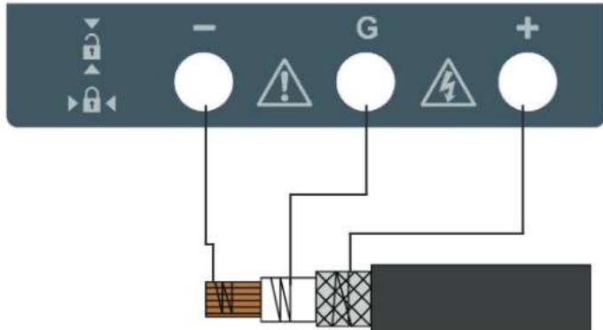
Como ilustrado no diagrama, o terminal de proteção está ao mesmo potencial que o terminal negativo. Uma vez que a resistência de fuga está efetivamente em paralelo com a resistência a ser medida, o uso da proteção faz com que a corrente, que flui através de fugas de superfície, seja desviada do circuito de medição. O instrumento, portanto, lê a fuga do isolador, ignorando fugas na sua superfície.
