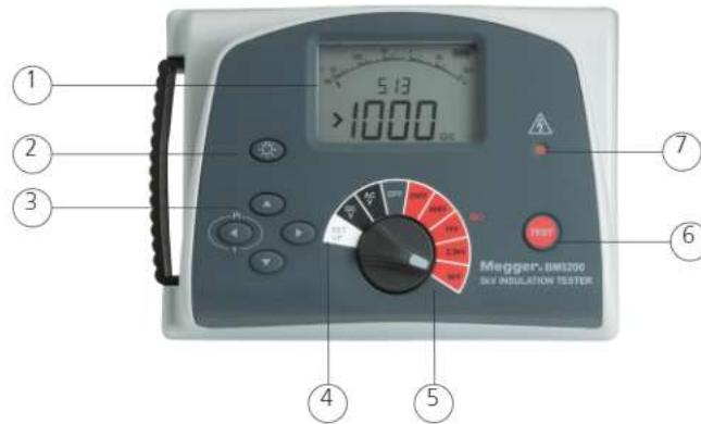
El BM5200 se enciende girando el interruptor principal a la prueba de aislamiento, prueba de voltaje o función de iniciación.
